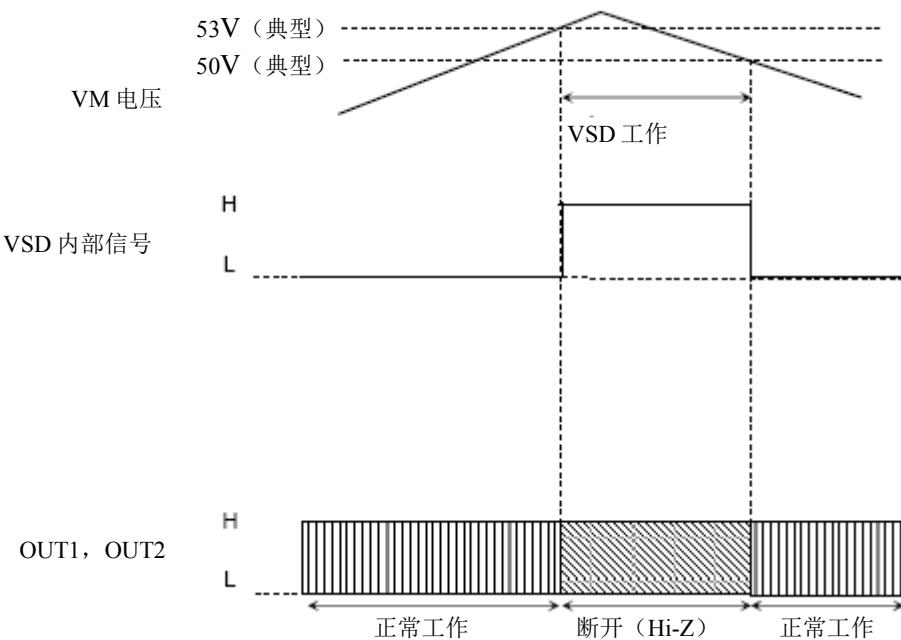
注: 一旦超过该绝对最高电压额定值, 该过电压关机电路即被启动。注意该电路仅为辅助性质, 不一定能为该集成电路提供针对任何类型损伤的完美防护。
