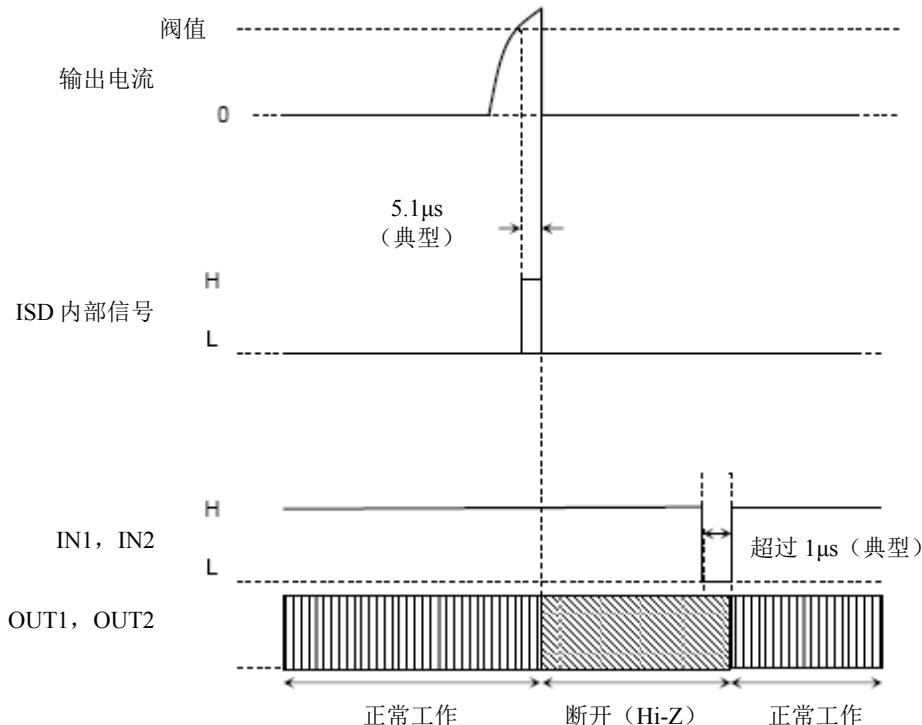
注：一旦超过该绝对最高电压额定值，该 ISD 即被启动。注意该电路仅为辅助性质，不一定能为该集成电路提供针对（由电源故障、接地故障、负载短路等因素形成过电流所导致的）任何类型损伤的完美防护。
