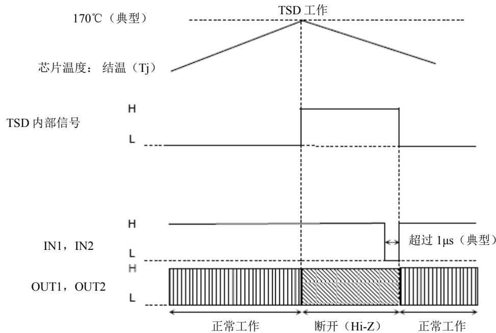
注：一旦结温 ( $T_j$ ) 超过额定温度 ( $150^\circ\text{C}$ )，过热关机电路即被启动。注意该电路仅为辅助性质，不一定能为该集成电路提供针对任何类型损伤的完美防护。
